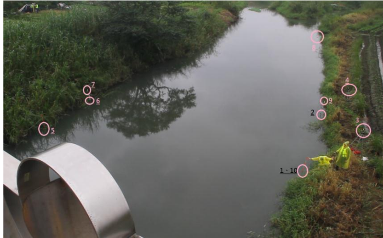
圖 6、宜蘭河員山大橋表面流速測試標定參考點
