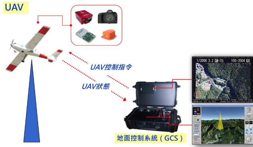
圖 3-50、國土測繪 1 號無人飛行載具系統架構
