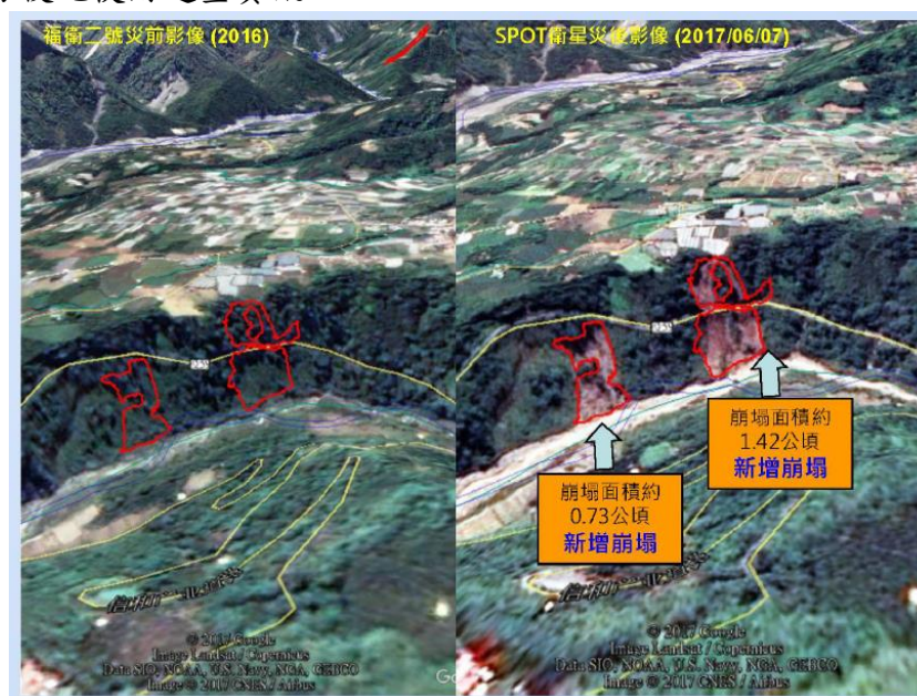
圖 3-11、SPOT-6 衛星影像進行災害影像變異分析
