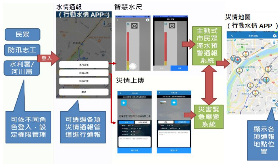
圖 37、行動水情 APP 智慧水尺影像辨識系統與通報流程架構圖
