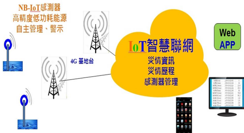
圖 117、NB-IoT 無線連續式積淹水感測器通報架構示意
