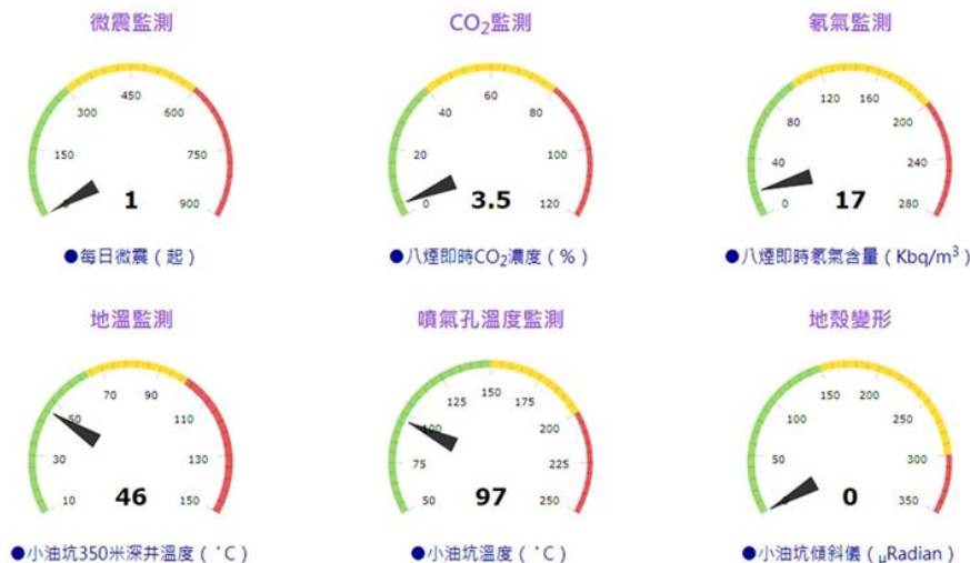
圖 6、大屯火山觀測站火山監測系統(圖取自臺灣火山活動監測網頁)
