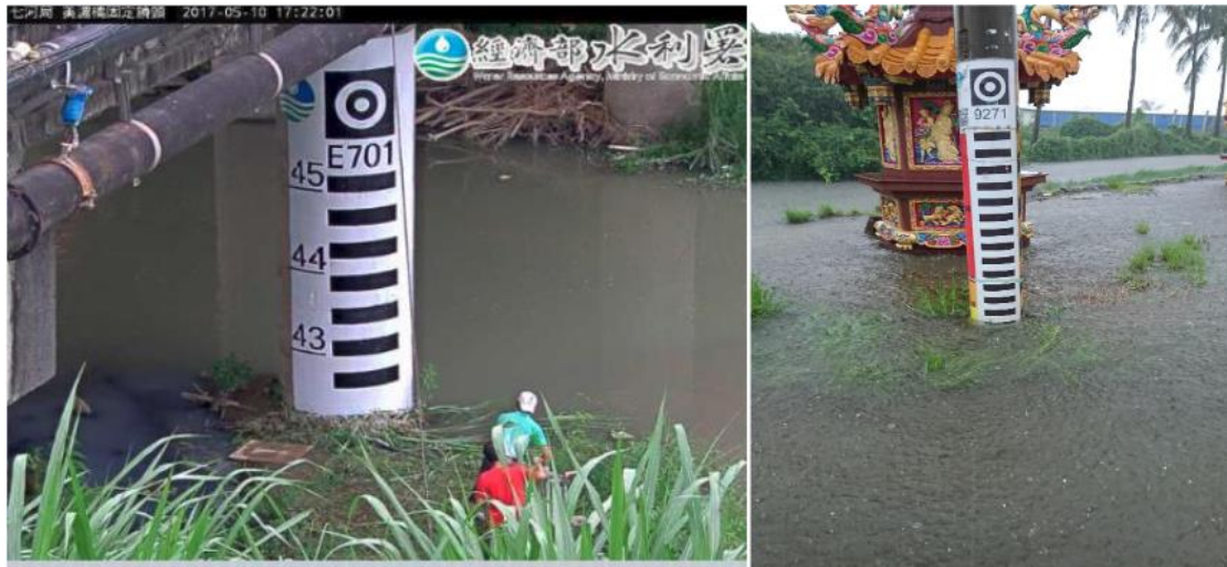
圖 36、影像監視器拍攝河川水位智慧水尺之截圖，主要用於河川水位警戒通報（左圖）；實際上傳之路面積淹智慧水尺照片，積水深度約 5 公分（右圖）
